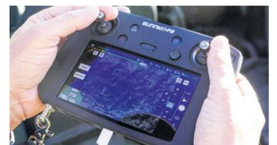
Effektives Ortungsinstrument: in Drohne integrierte Wärmebildkamera
